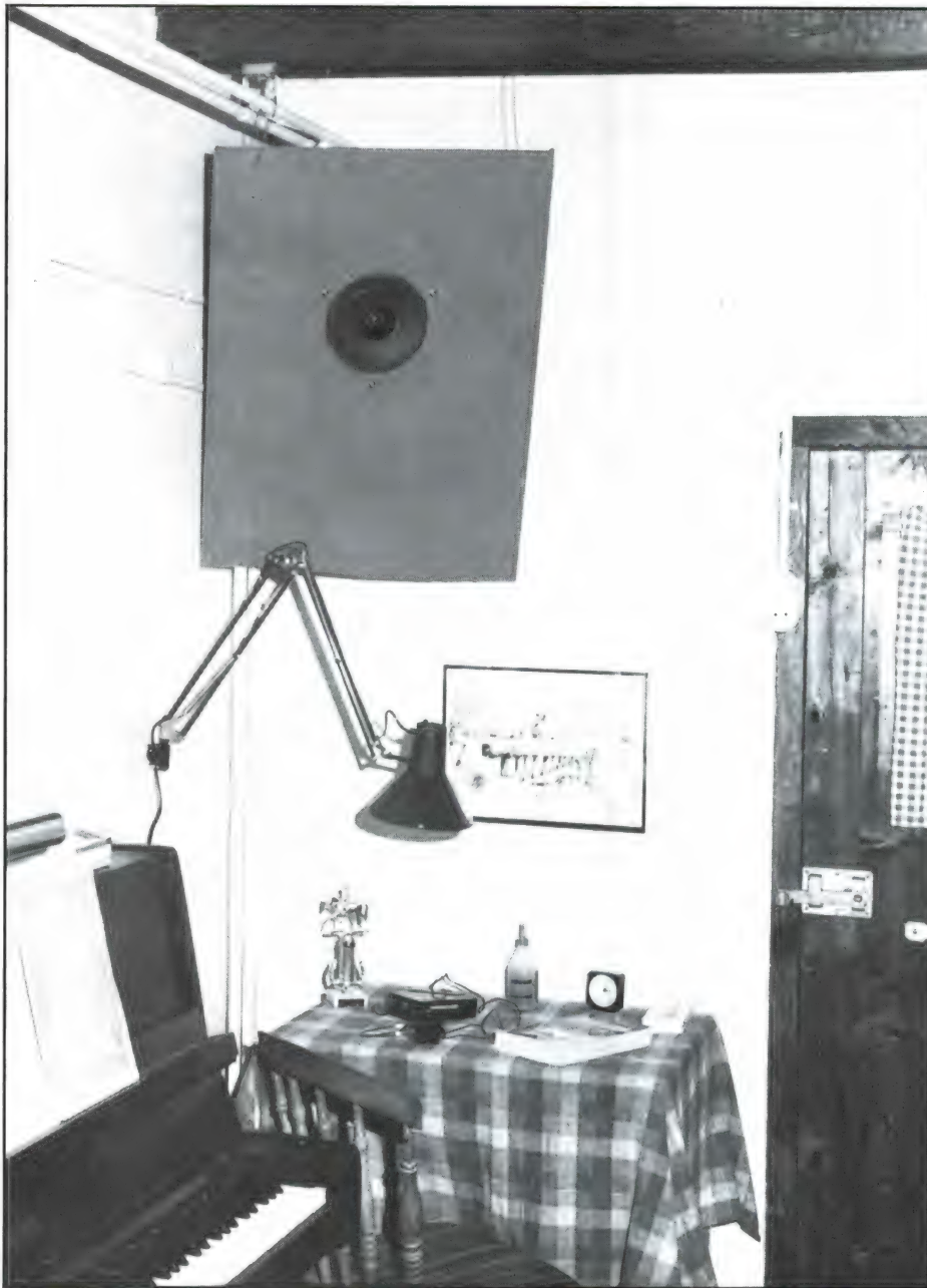
Foto 3. Het klankbord met luidspreker aan het plafond opgehangen. Als klankbordmateriaal is hier dik onderlegvilt, dat onder vloerbedekking wordt gebruikt, toegepast. Dit materiaal is akoestisch aardig dood. Een harde plank (meubelplaat o.i.d.) kan gaan resoneren. Een goede methode is: stevig materiaal gebruiken en dit aan de achterkant met onderlegvilt bekleden.
